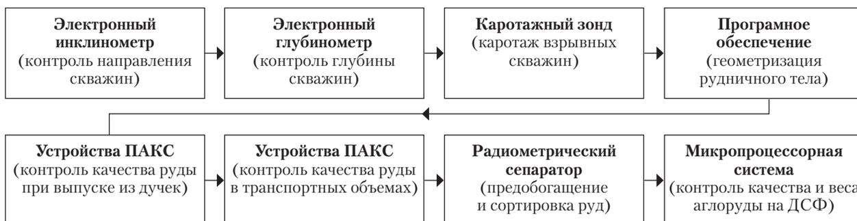
Рис. 2. Комплекс технических средств, обеспечивающий снижение потерь и засорение железных руд
