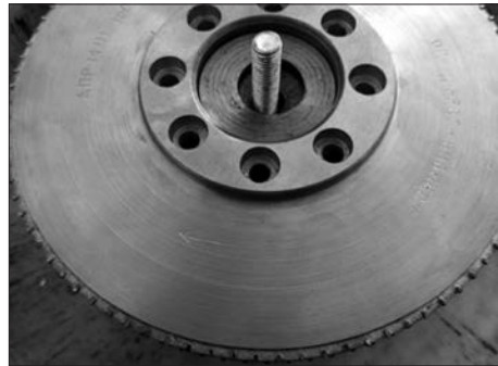
Рис. 5. Правлячий ролик з CVD-алмазу
