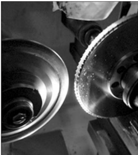
Рис. 4. Доводка ролика на оптико-шліфувальному верстаті
