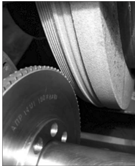
Рис. 6. Правлячий ролик з CVD-алмазу при праці шліфувального круга
