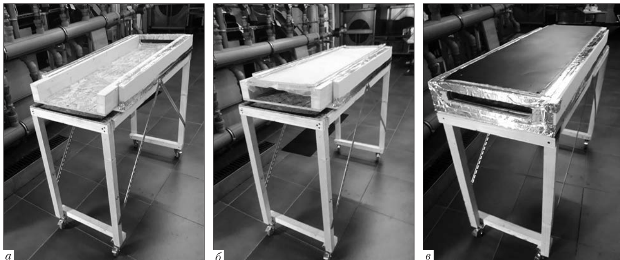
Рис. 2. Етапи виготовлення термоактивної покрівельної панелі: а – формування дерев'яного каркасу; б – МФП в опалубці; в – готовий зразок
