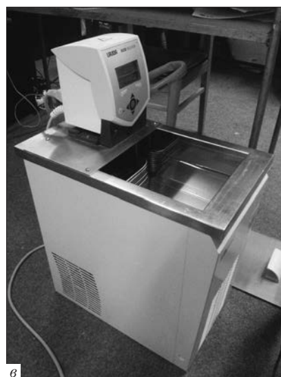
Рис. 5. Обладнання, використане в дослідженні: а — термомпари; б — вторинний вимірювальний прилад; в — резервуар для калібрування LAUDA ECO Silver
