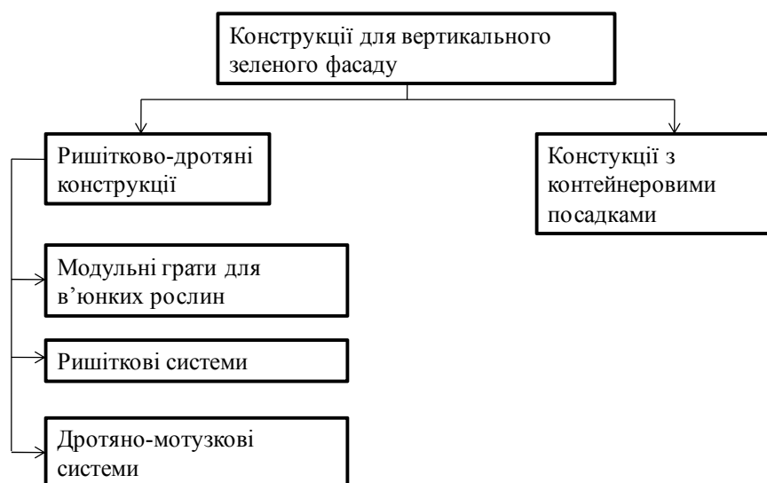
Рис. 1. Класифікація підтримуючих конструкцій для створення вертикальних зелених фасадів Побудовано автором на основі даних [4, с. 589].
