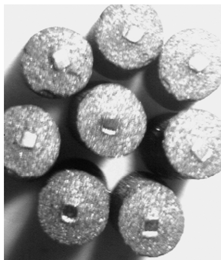
Рис. 2. Образцы АПКМ с добавкой Ni–Co–WC, армированные пластиной поликристаллического CVD-алмаза (в центре цилиндров).
