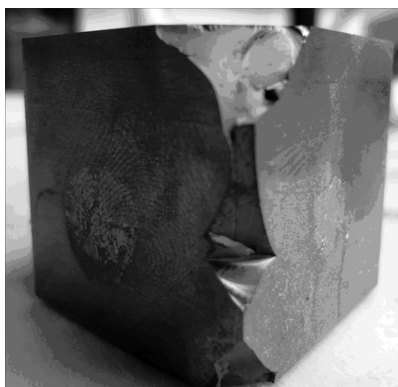
Рис. 5. Зруйнований пуансон другого ступеня АВТ 6-8.
