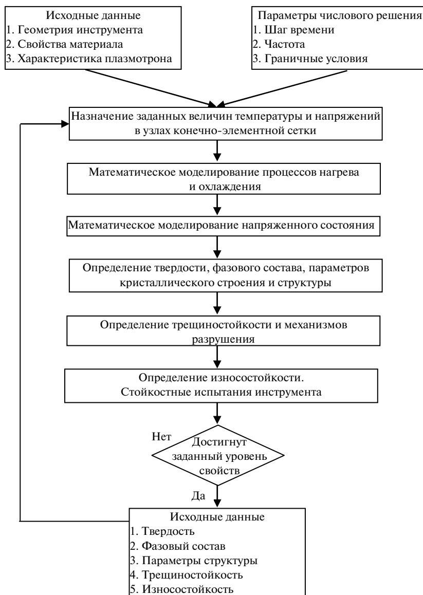
Рис. 1. Структурная схема синтеза модифицированных слоев на инструментальных твердых сплавах.
