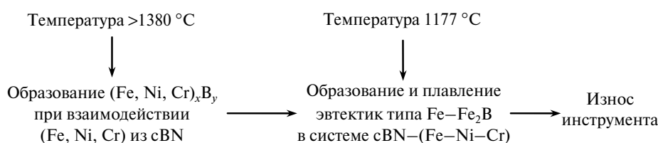
Рис. 1. Модельная схема химического взаимодействия инструмента из ПКНБ с Fe-Ni-Cr.
