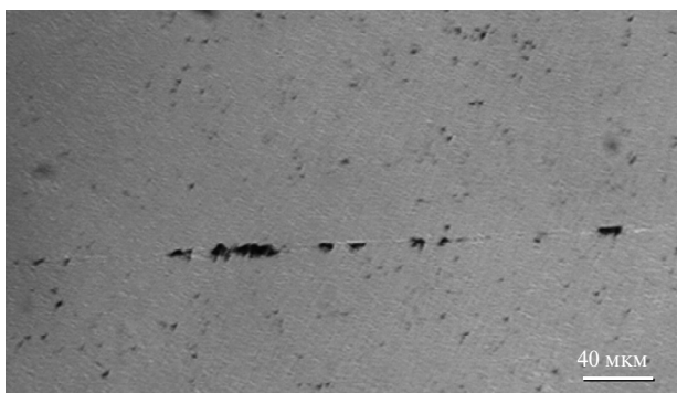
Рис. 4. Зона контакта шлифованных образцов с шероховатостью 10 мкм.
