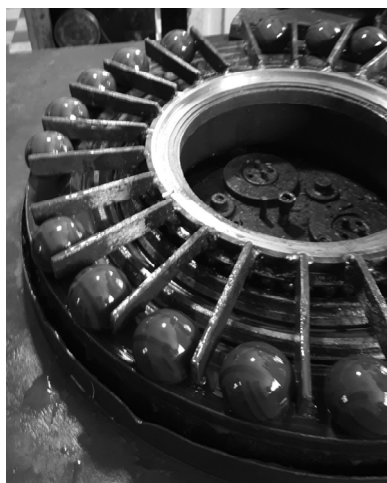
Рис. 2. Керамічні кулі у сепараторі на нижньому притирі верстата мод. 3Е-814.
