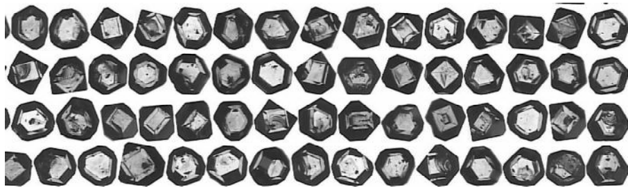
Рис. 1. DiaInspect-світлини зерен порошків: а – AC200 800/630; б – електрокорунд; в – карбід вольфраму; г – річковий пісок.
