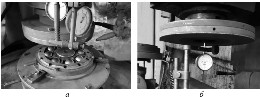
Рис. 2. Розташування керамічних куль у пристрої (а), вимірювання координати профілю робочої поверхні круга (б).
