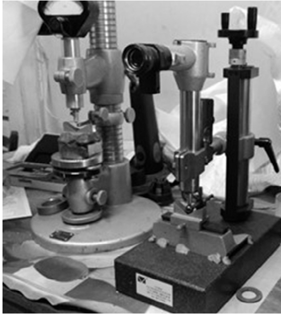
Рис. 2. Прилади для вимірювання діаметра кулі, його варіації з точністю 1 мкм (праворуч) і 0,1 мкм (ліворуч).
