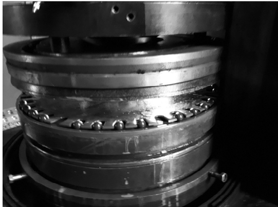
Рис. 1. Розташування керамічних куль у сепараторі на шарикодвідному верстаті.
