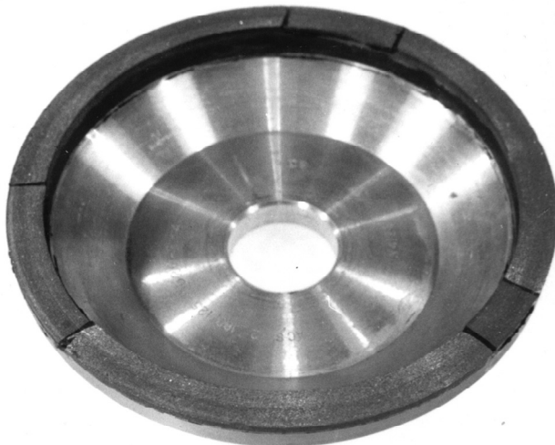
Рис. 16. Конструкція різального секторного круга з різним робочим шаром в секторах, що чергуються в коловому напрямку.
