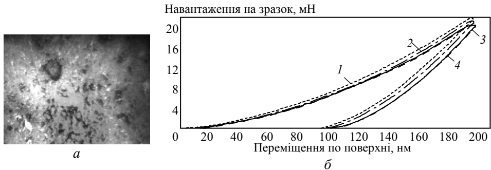
Рис. 12. Фрактограма (а) і характеристика (б) фази карбіду кремнію за нанотвердості E = 446 \pm 15 ГПа та модулю пружності H = 30,6 \pm 2 ГПа.
