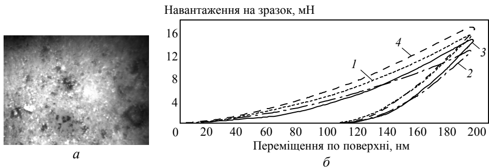
Рис. 13. Фрактограма (а) та характеристика (б) фази оксиду алюмінію за нанотвердості E = 348 \pm 29 ГПа та модулю пружності H = 19,5 \pm 3 ГПа.
