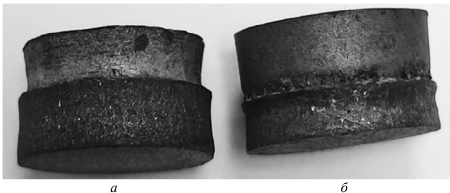
Рис. 1. Порівняння високопористого порошкового сплаву-розчинника Fe-35Ni, отриманого шляхом ізостатичного пресування (а), зі зразком, що відлито після вакуумно-індукційного перепау (б) і проведення циклу вирощування ( p = 6,5 ГПа і T = 1400 °С).
