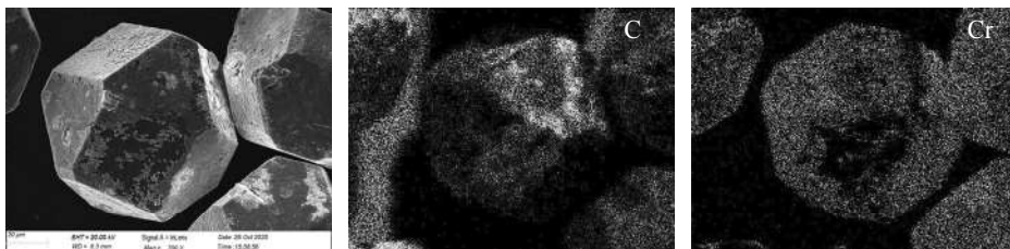
Рис. 6. EDS-карти елементів 4 % (за масою) Cr/алмаз після термічної обробки за температури 950 °С протягом 60 хв.
