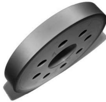
Рис. 17. CVD алмазний шліфувальний круг форми 1A1 діаметром 80 мм: під час ( a ) та після ( б ) нанесення покриття методом HFCVD [47].
