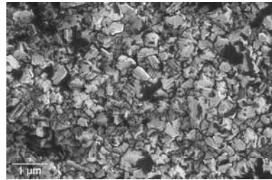
Рис. 18. Алмазні торцеві шліфувальні круги для шліфування скла діаметром 125 мм, корпус з графітової основи ( a ), нанесений шар CVD алмазів, зображення SEM ( б ) [47].
