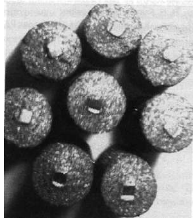
Рис. 6. Зразки АПКМ з добавкою Ni-Co-WC, армовані пластиною полікристалічного СVD алмазу (в центрі циліндрів) [28].
