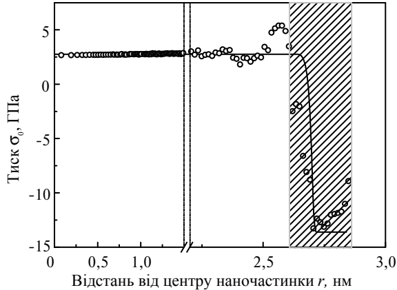
Рис. 4. Напруження всебічного розтягу/стиску \sigma_0 як функція відстані від центру наночастинки.
