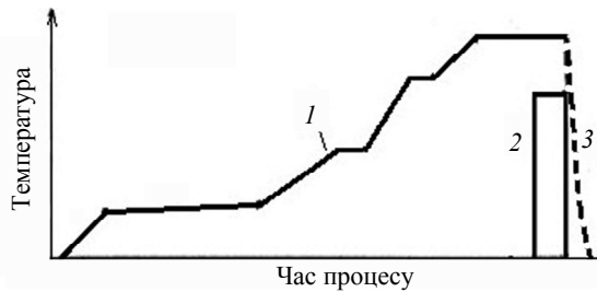
Рис. 1. Режим вакуумно-компресійного спікання за тиску газу 5 МПа в печі фірми “ALD Vacuum Technologies GmbH” [1]: спікання за тиску аргону (1), стадії напускання газу (2) та охолодження (3).
