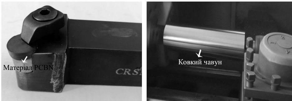
Рис. 6. Зображення різального інструмента і заготовки з ковкого чавуну.
