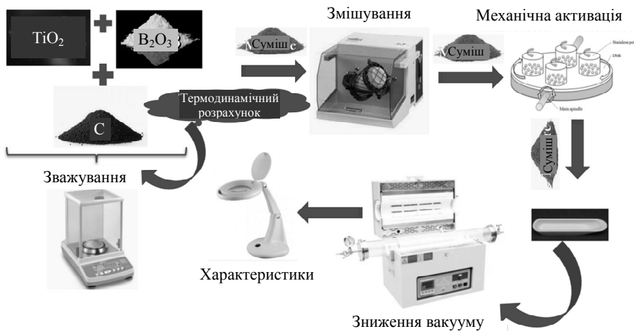
Рис. 1. Блок-схема експериментальних досліджень.
