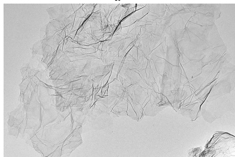
Рис. 3. SEM ( а , б ), ТЕМ ( в , г ) зображення продукту, отриманого після термічної обробки ОГ за температури 250 °С протягом 1 год.
