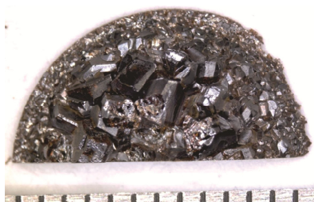
Рис. 6. Характерні риси кристалізації GaN за умов \text{grad}T_z = 13,6 \text{ }^{\circ}\text{C}/\text{мм} : стиснений ріст GaN; оптичне зображення, ціна поділки на шкалі – 1 мм.
