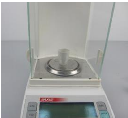
Рис. 2. Електронні терези з бюксом, що містить висічку
