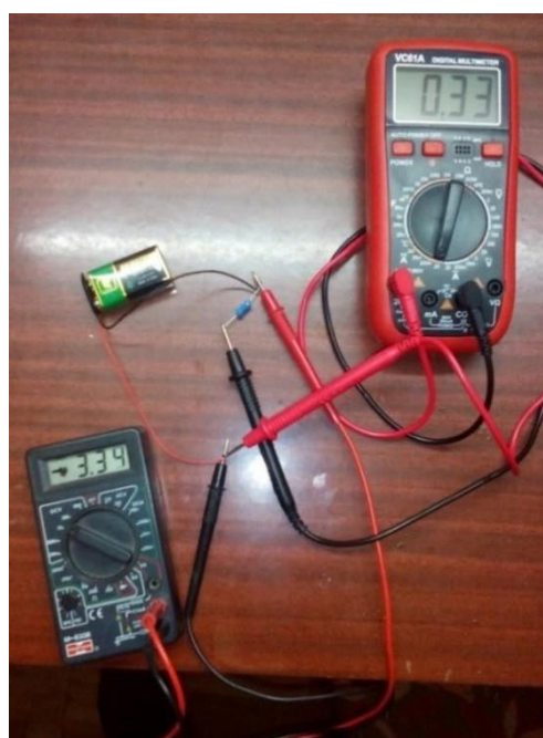
Рис. 11. Вимірювання внутрішнього опору батарейки – доповнення віртуального практикуму натурним
