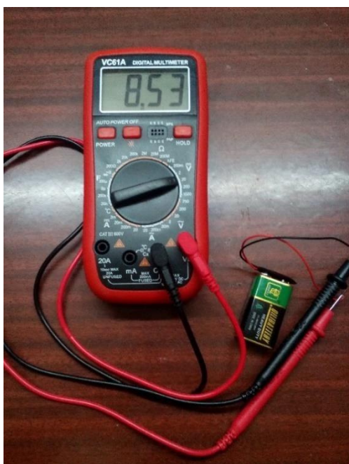
Рис. 11. Вимірювання внутрішнього опору батарейки – доповнення віртуального практикуму натурним
