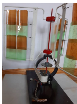
Діюча модель портативної вітроустановки для живлення малопотужних пристроїв
