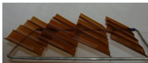
Діюча модель хвильового рушія
