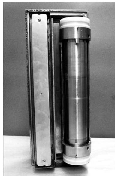
Рис. 8. Общий вид блока катодного узла тлеющего разряда и дуготрона с кобальтовым катодом
