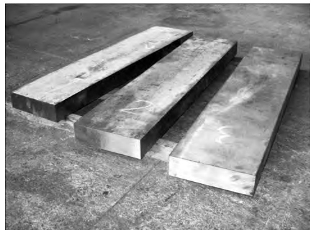
Рис. 2. Внешний вид слитков-слябов никеля
