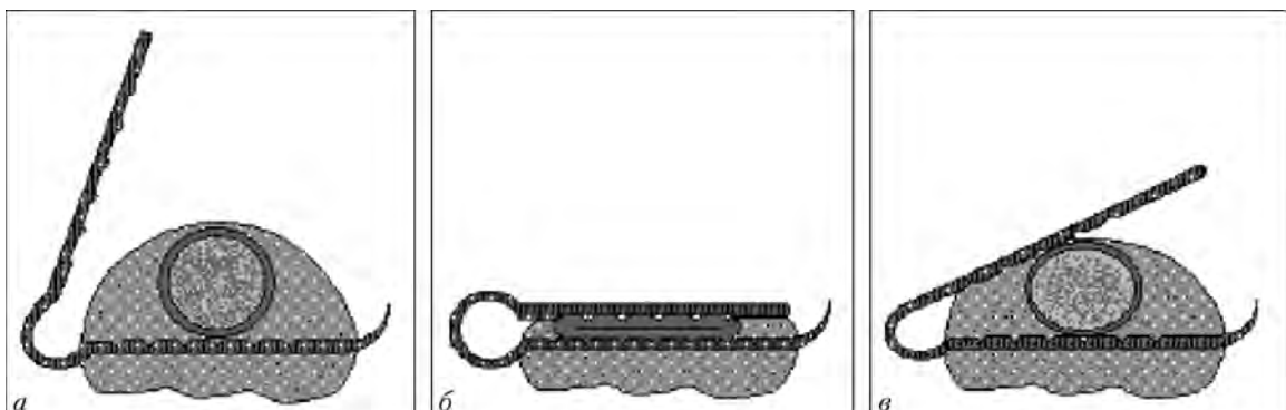
Рис. 3. Схема действия клипсы: а — обхват сосуда и «прошивание» тканей; б — обжатие сосуда за счет ЭФП материала клипсы, в — освобождение сосуда за счет обратного ЭФП материала клипсы ( T = 20...25\text{ }^{\circ}\text{C} )
