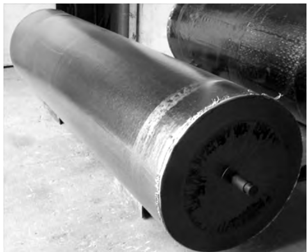
Рис. 3. Внешний вид оплавленного слитка титанового сплава ВТЗ-1 диаметром 840 мм
