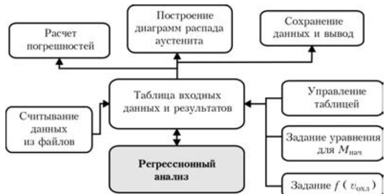
Рис. 5. Блок-схема программы; M_{нач} — температура начала мартенситного превращения
