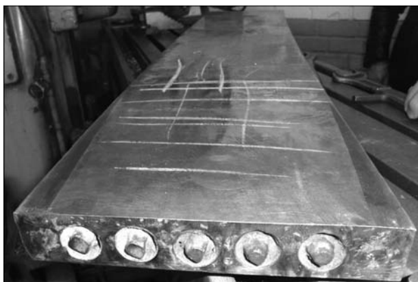
Рис. 1. Медная плита кристаллизатора МНЛЗ после эксплуатации
