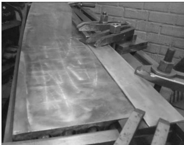
Рис. 5. Образец плиты в собранном виде перед наплавкой медным листом 3 мм
