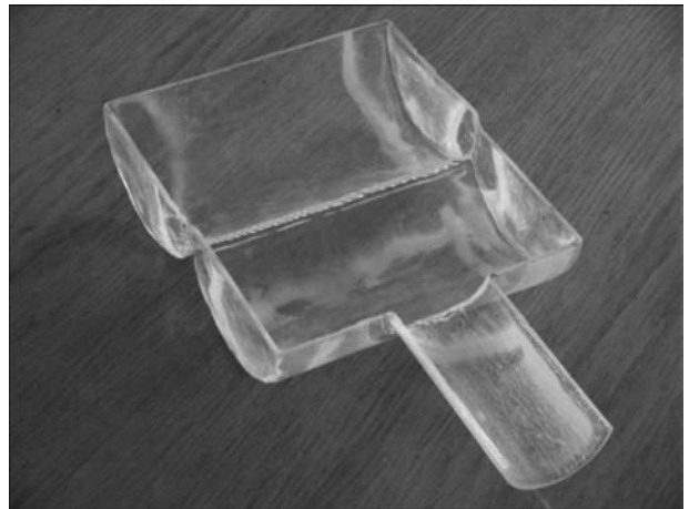
Рис. 3. Двухсекционная кварцевая промежуточная емкость со сливным лотком
