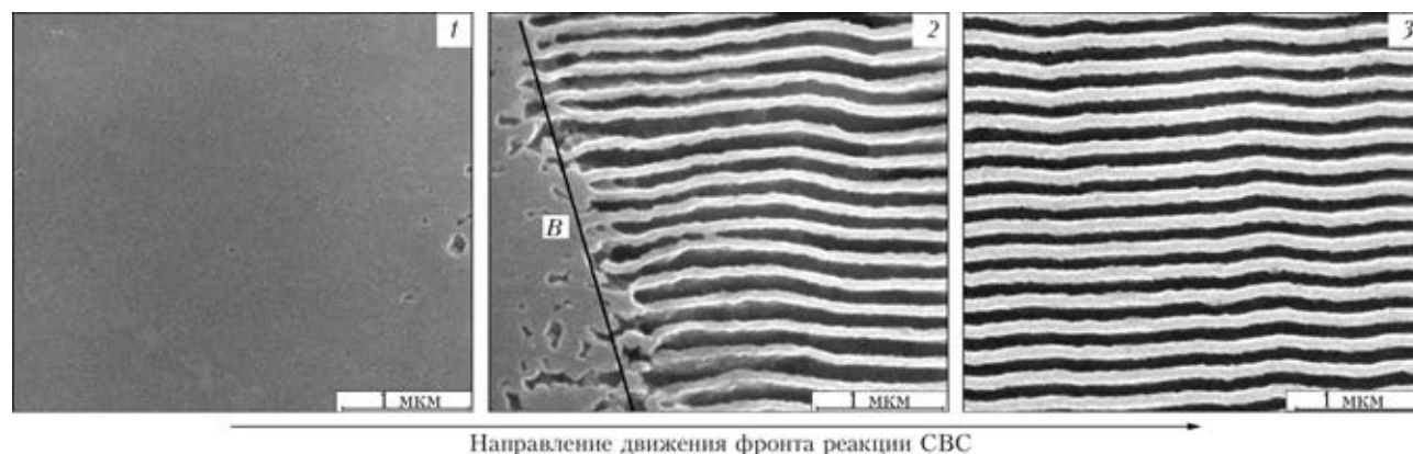
Рис. 7. Электронно-микроскопическое изображение структуры поперечного сечения многослойной фольги Al/Ni после прохождения реакции СВС, остановленной закалкой фольги в воду; поз. 1–3 см. на рис. 6
