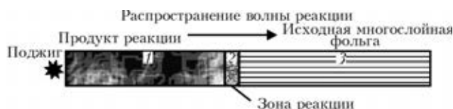
Рис. 6. Схема реализации реакции СВС в многослойной реакционной фольге: 1 — после прохождения реакции; 2 — фронта реакции; 3 — непрореагировавшая или частично прореагировавшая фольга
