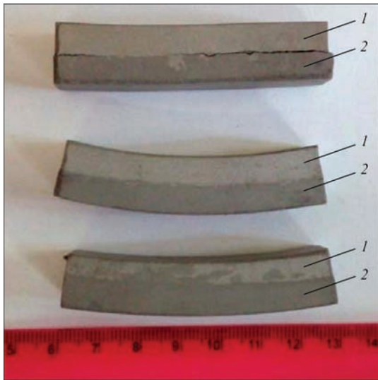
Рис. 2. Внешний вид спеченных двухслойных образцов: 1 — Ti-6Al-4V; 2 — Ti-6Al-4V-10TiB
