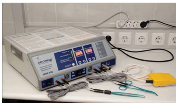
Рис. 24. Апарат для зварювання живих тканин ЕКВ3-300 «Патонмед»
