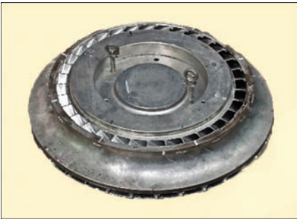
Рис. 19. Центробіжне колесо компресора газотурбінного двигуна, яке виготовлено із застосуванням нового припою
