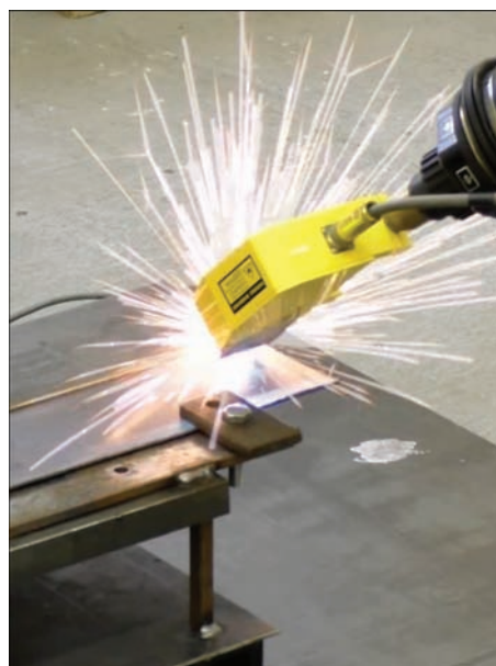
Рис. 14. Зварювальний робот з системою технічного зору [7]
