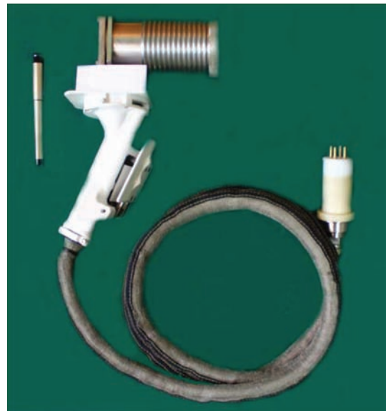
Рис. 7. Ручна електронно-променева гармата з високовольтним роз'ємом
