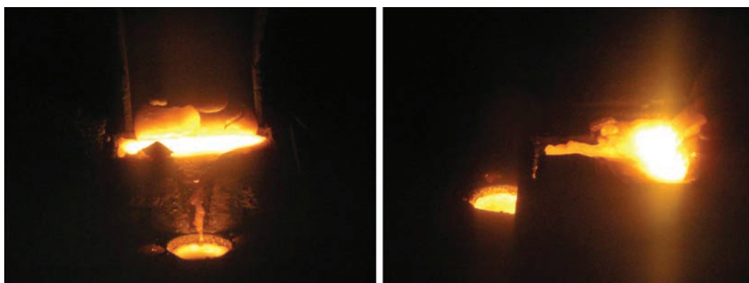
Рис. 8. Процесс выплавки слитка сплава системы Ni–Al–Cr
