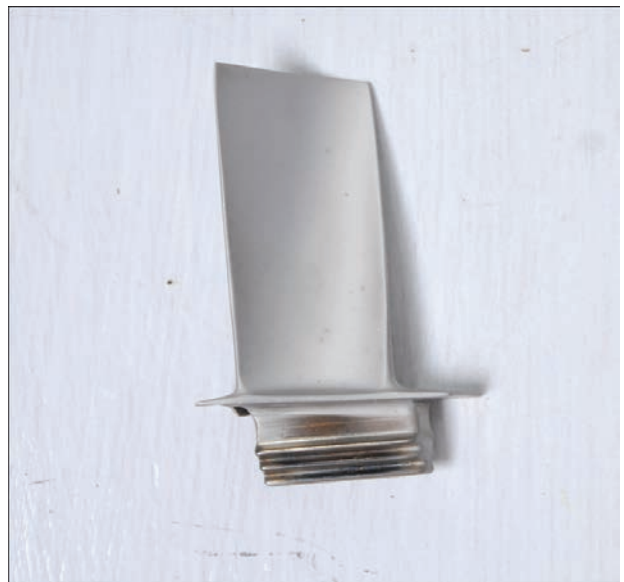
Рис. 6. Внешний вид лопатки из сплава ЖС6 с вакуумно-дуговым покрытием СДП-6, нанесенным на перо данной детали
