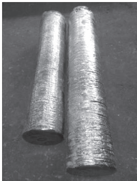
Рис. 8. Внешний вид слитков диаметром 150 мм сплава Т110
