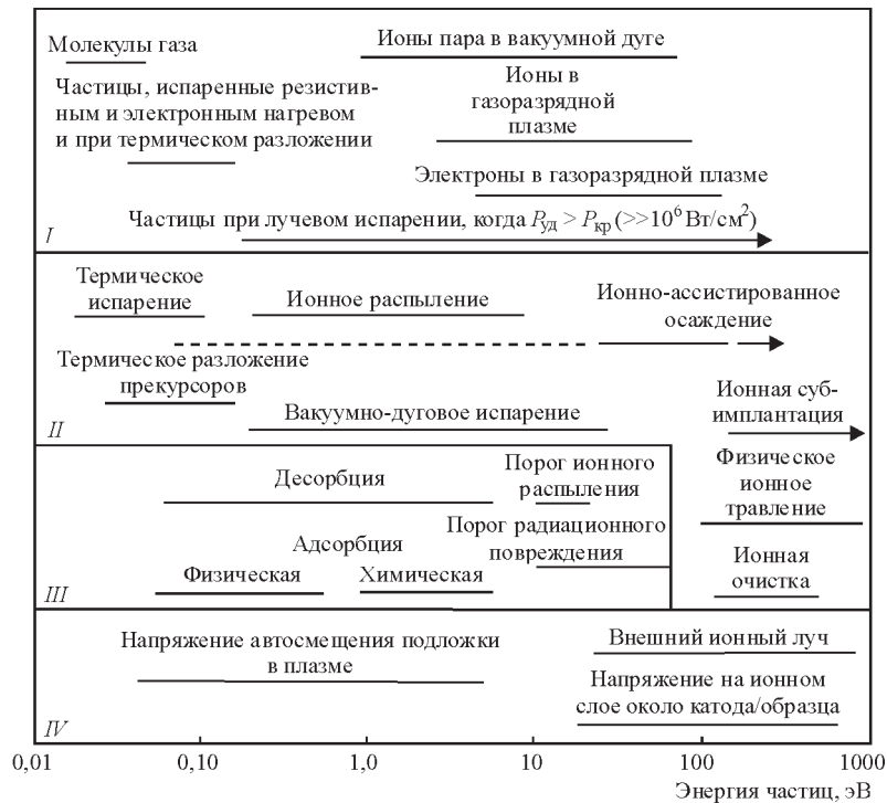
Рис. 1. Энергетические диаграммы процессов при осаждении покрытий методами физического (PVD) и химического (CVD) осаждения с паровой фазы: I — энергия частиц, генерируемых в камерах осаждения около источника наносимого вещества; II — энергия частиц, воздействующих на подложки и конденсат в различных методах осаждения и дополнительной обработки; III — энергетические характеристики некоторых базовых процессов на поверхности подложек; IV — энергетические характеристики внешнего ионного луча и электрического воздействия на ионы из плазмы
