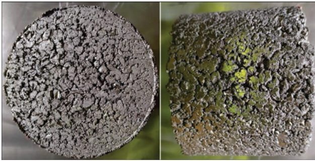
Рис. 2. Зовнішній вигляд пресованих брикетів діаметром 150 мм з дробленого губчастого титану
