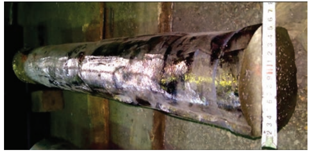
Рис. 5. Зовнішній вигляд електрода з повністю обробленою поверхнею електронним променем по схемі I
