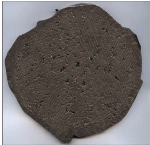
Рис. 7. Поперечний темплет оплавленого електрода променем поверхню — 95 при кімнатній температурі та 25 при 600 °С.
