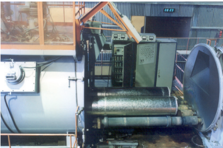
Електронно-променева установка UE185 для оплавлення поверхні зливків
