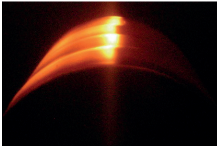
Процес оплавлення зливку титану діаметром 1100 мм
