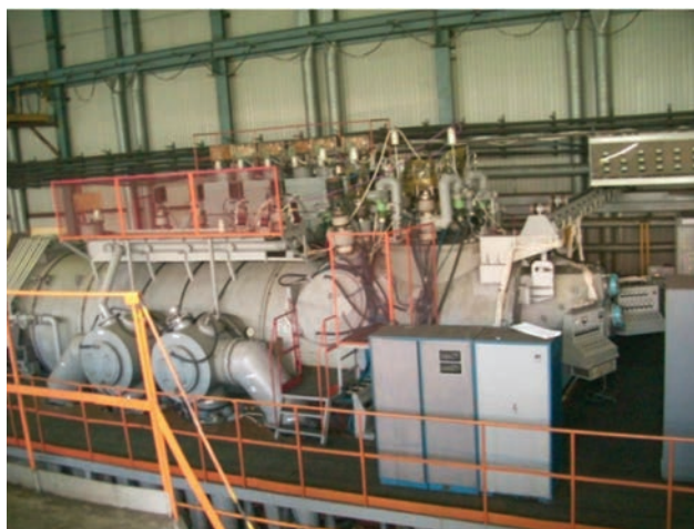
Електронно-променева установка для виплавки титанових зливок діаметром до 1100 мм та масою до 20 т
