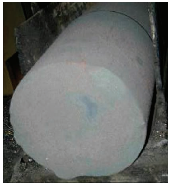
Рис. 3. Заготовка циліндричної форми з порошку заліза та SiC лігатурою
