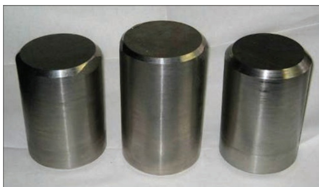
Рис. 7. Зовнішній вигляд зливків заліза діаметром 200 мм після токарної обробки їх поверхневого шару
