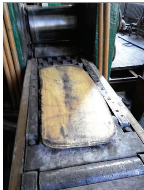
Рис. 3. Пластина розмірами 300×600×10 мм зі сплаву Ti–2,8Al–5,1Mo–4,9Fe
