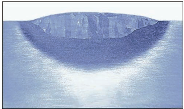
Рис. 1. Макроструктура наплавлення, отриманого присадним металопорошковим дротом
