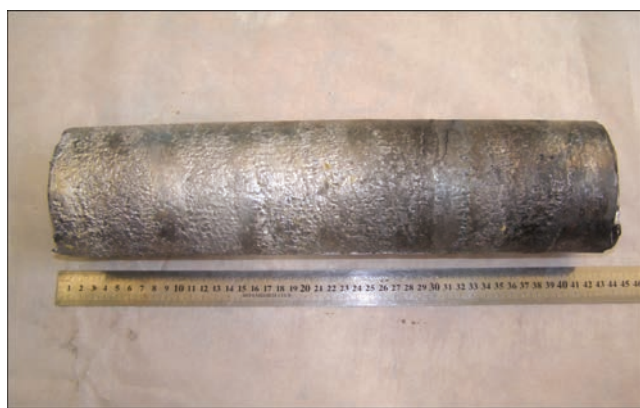
Рис. 2. Зливки сталі ШХ-15, виплавлені на печі УПП-3 талу азоту спостерігалось, головним чином, коли він перебував в розплаві у вигляді нітридів.
