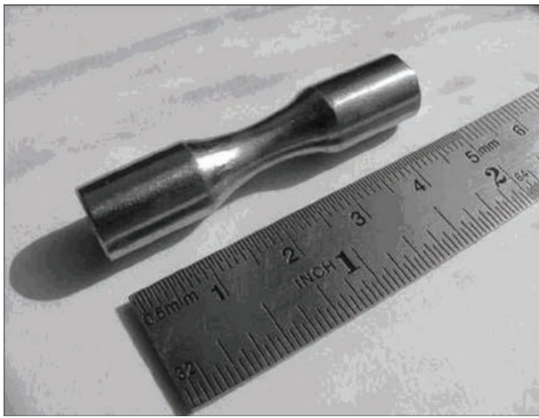
Рис. 4. Зразок для випробувань на розтяг після ІБЗП [14]
