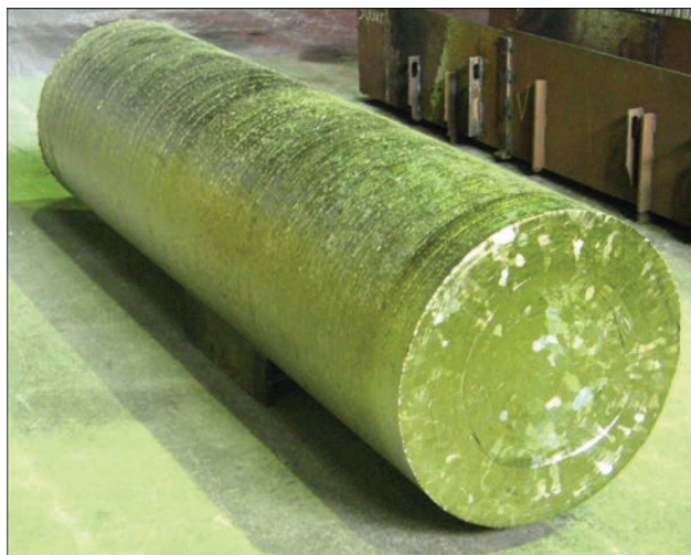
Рис. 3. Зливки титанового сплаву Grade 2 діаметром 600 мм після ЕПП
