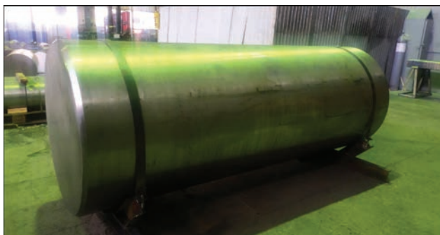
Рис. 4. Зовнішній вигляд зливка титанового сплаву Grade 3 діаметром 1100 мм після механічної обробки
